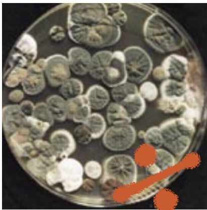
Образец из компрессора без осушителя - влажность в воздухе - идеальные условия для развития бактерий.
